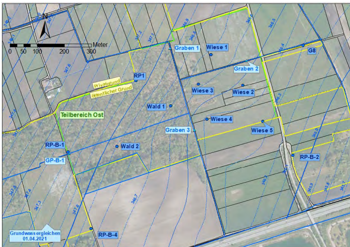
Abbildung 63: Teilbereich Ost – derzeitige Verhältnisse (GP = Grabenpegel, RP = Rammpegel, die mit Wiese , Wald oder Graben bezeichneten Pegel werden derzeit durch die TU München betrieben); Grundwassergleichen: eigene Messwerte
